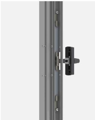
3. 例如：安装F30A（F30EU24）执手，开两个固定螺丝孔中心距为98mm，开一个长方孔70×5mm，使拨叉穿过长方孔，插入FB10H传动器中，再用已穿上防脱戒子的M5圆头螺丝扭入执手上固定的螺丝孔，再将执手固定于面墙上。
