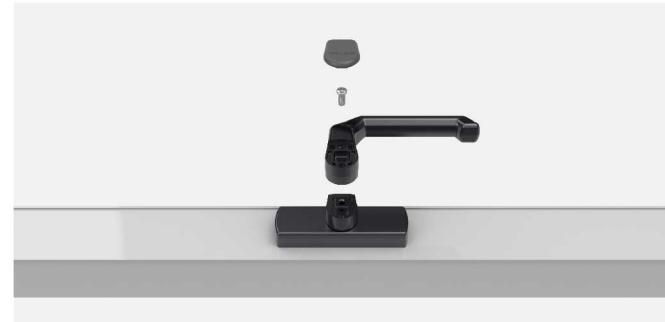
3.窗户安装完成后，若需要调换执手的方向，可揭开封盖，扭出执手里的盘头螺丝，把手便可与底座分离，再调换到合适的方向后，重新上紧螺丝固定并盖上封盖，即可完成执手方向的调换。
