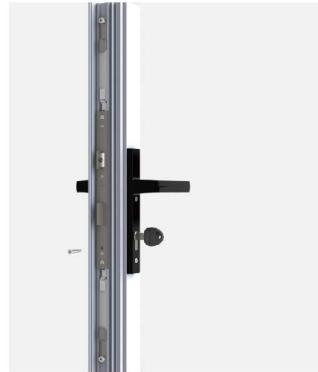
4.把一颗M5沉头螺丝，扭入锁体下方的圆孔，对准锁芯上的螺丝孔，使锁芯与多点锁锁体固定，实现内外开启的防盗作用。
