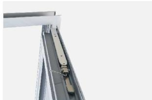
窗扇在受重力作用下使执手侧产生微量下垂时，可将窗扇处于平开状态，用内六角扳手顺或逆时针调节隐藏于斜拉杆调节器内的螺钉，使窗扇达到水平，实现开启灵活。
