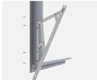
1.窗扇窗框之间一般距离为16.5mm—17mm。悬撑包角厚度为2.5mm，由此得出：第四杆头到窗扇边角位一般为14mm—14.5mm，计算好位置，之后根据第四杆的螺丝孔的形状上螺丝并固定（有倒角螺丝孔的，使用沉头螺丝；无倒角螺丝孔的，使用盘头螺丝）。
