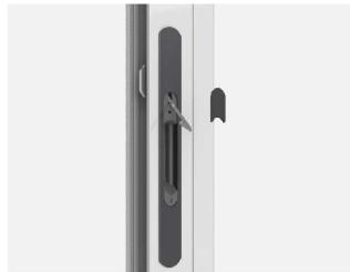
3.将锁钩插入到适当位置后，用扳手扭紧锁上内置的内六角螺钉，使锁钩固定，最后盖上封盖，使外观更整洁、美观。
