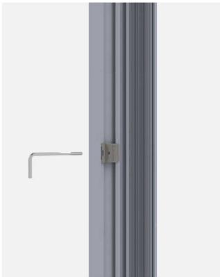
4. 根据传动杆的偏心钉位置安装F14CI锁扣。用六角匙扭紧锁扣内的内尖螺丝，使锁扣固定在欧槽型材上。
