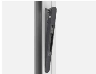
1.在型材上开一188x20的长方形孔，将TLHT推拉锁固定的一边（如图），先插入长方孔的一边，再用力将TLHT推拉锁推进长方孔。
