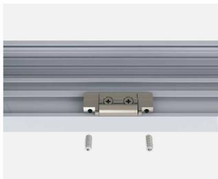
3.将F9CIK中间锁扣装入窗框的型材内，与F9CIS中间锁扣位置对应。锁紧内置的斜顶螺钉，固定于窗框内。
