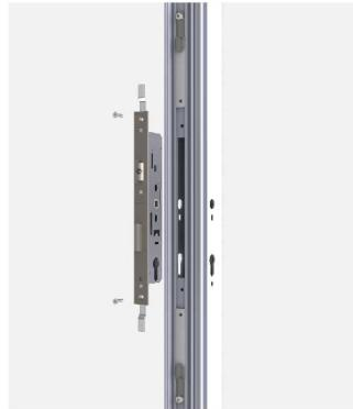
2.根据型材选用合适的多点锁锁体，根据多点锁锁体的尺寸在型材上开孔，多点锁锁体两头有不锈钢连接头与连接杆连接，用M4自攻螺丝固定多点锁锁体。
