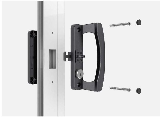
安装TLXTS推拉锁，首先根据型材需要，选用合适的推拉锁钩，然后在型材上开两个直径11mm螺丝孔，中心距为138mm，再开一个25x28mm的长方孔；最后把TLXTS中带有推拉锁钩部分放入长方孔中，再使用M5沉头螺丝插入TLXTS中的两个螺丝孔，并拧入对面的TLXL推拉锁的带丝螺孔中，使其固定在型材上。
