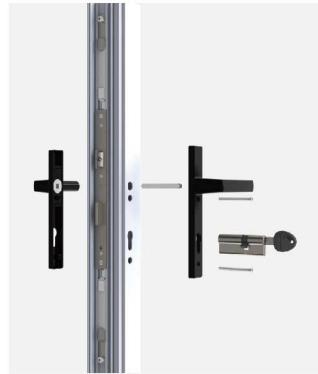
3.待多点锁锁体固定后，插入配置好的8mm轴，再装上平开门执手，然后扭上两颗M5沉头螺丝，将其固定（平开门执手上穿孔螺丝的一边需要安装在室内使用，才能起到最佳防盗作用）。
