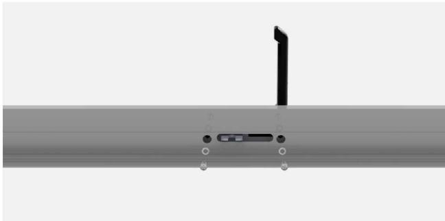
1.F69A (F30EU24)适用于悬窗，属于单向传动。安装时首先在扇料第一层钻约11mm的螺丝孔，在第二层钻约5.5mm的螺丝孔，对准执手的螺丝孔，用盘头螺丝配上的防脱戒子固定执手底座。
