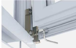
NDHYB01下铰页固定部分合页采用不左右锁紧设计，活动合页采用不左右球体钢轴支点设计，能使窗扇开启或内倒时灵活转动窗扇。合页上的“L”型轻合金压片采用夹紧设计，底部有8mm内六角螺钉，合页安装后可以轻松调节窗扇高低水平。
