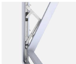
2.用悬撑把窗扇与窗框连接，悬撑打开到最大角度，包角头应顶住窗框边缘，底槽上的螺丝孔用盘头螺丝固定。
