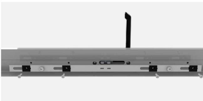
2.非欧槽型材的悬窗使用LG04传动杆，执手上的拨叉插入传动杆的相应的长方孔里，计算好位置后使用沉头螺丝固定。
