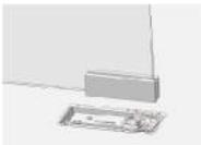
D. 依次把装上玻璃的门夹，对准地弹簧的凸点，进行组合安装；
