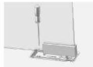
F. 利用螺丝刀，扭动地弹簧尾端的螺丝，进行上下微调；
